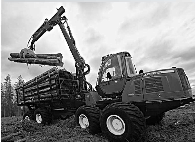
在业界生产率最高的集运机中，John Deere 1910E 集运机的特点是装卸重物时的绝佳速度和力度。该机型的优势在于其有效负荷增加了 2 吨，动力、液压泵能力和牵引力更强劲。E 系列机器还拥有可旋转和可调平的驾驶室，可以提高工作效率并为驾驶员提供更开阔的工作视野。
