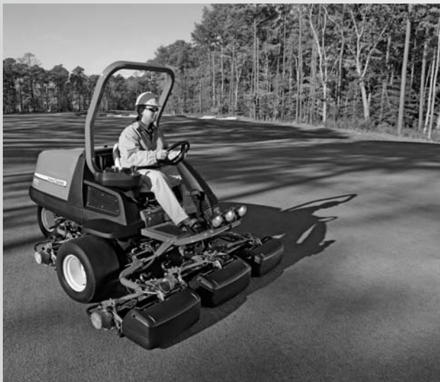
作为公司迄今为止推出的最大高尔夫球场养护设备，7500 E 割草机是采用混合动力技术的三种新球道型号之一。该机器具有更强劲的动力，提供更低的操作噪音，并降低了燃油消耗量。电动切割机组降低了液压泄漏的风险。
